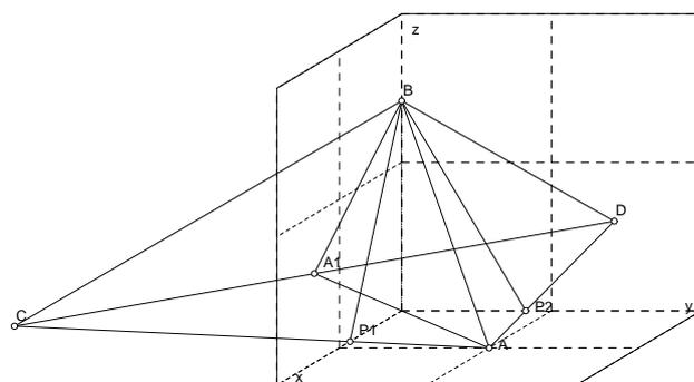
b) Eine andere Berechnungsmethode wäre, die Punkte  $P_1(p/0/0)$  und  $P_2(0/p/0)$  mit Hilfe eines noch offenen, positiven Parameters  $p$  anzusetzen und nur zu verlangen, dass die Ebenen  $ABP_1$  und  $ABP_2$  senkrecht zueinander stehen sollen.
